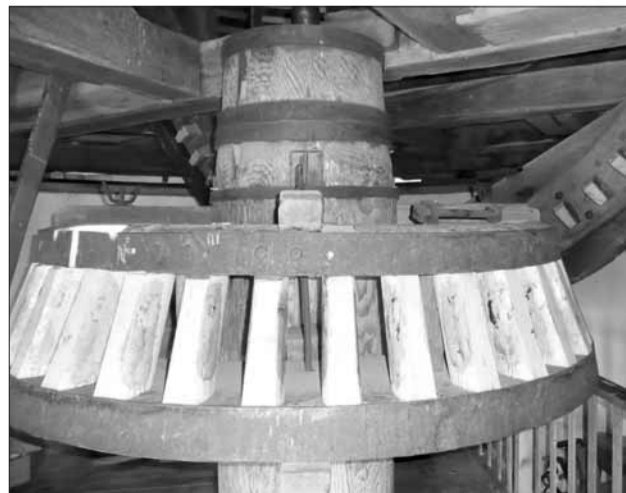
Winkelgetriebe von der horizontalen Flügelwelle zur vertikalen Königswelle
