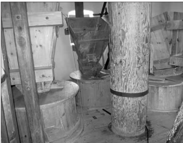
Die drei Mahlwerke für die verschiedenen Feinheitsgrade des Mehls
